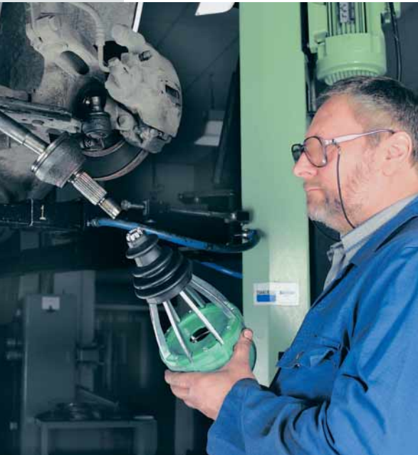
Schneller geht's kaum: Achsmanschetten lassen sich mittels eines pneumatischen Achsmanschettenwerkzeugs wie dem ‚QJB100TD‘ von Quinton Hazell im Handumdrehen montieren. Bilder: Quinton Hazell
