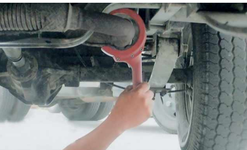
Schneller Schnitt: Mit Hilfe eines Rohrabschneiders, etwa dem Modell von Kunzer, lassen sich Auspuffrohre ohne Demontage am Fahrzeug abschneiden. Bild: Kunzer
