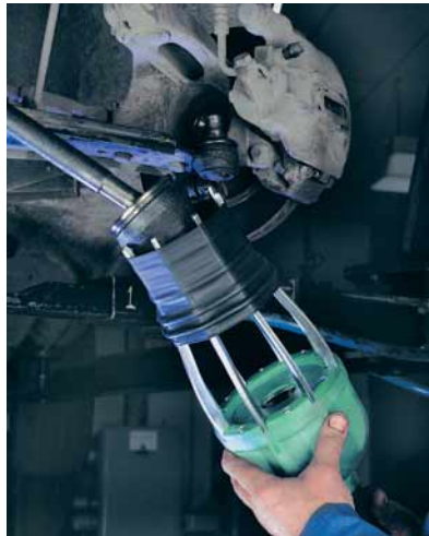
Schneller geht's kaum: Achsmanschetten lassen sich mittels eines pneumatischen Achsmanschettenwerkzeugs wie dem ‚QJB100TD‘ von Quinton Hazell im Handumdrehen montieren. Bilder: Quinton Hazell
