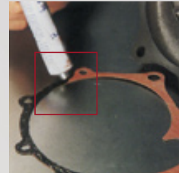
Empfehlung: Dichtmittel immer in der richtigen Verhältnis-mäßigkeit zur Dichtfläche einsetzen und diese nur dünn mit Dichtmittel benetzen.
