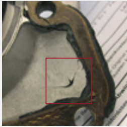
Unnötiger und übermäßiger Auftrag von Dichtmittel.
