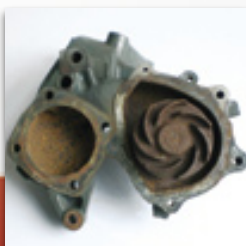
Zerstörung durch Korrosion.
