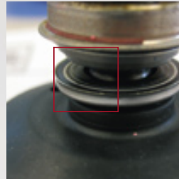
Dichtmittelanhaftungen auf dem Gleit- und Gegenring der Gleitringdichtung.
