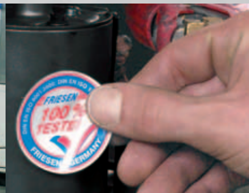
Prüfsiegel wird nach erfolgreicher Endprüfung geklebt.
