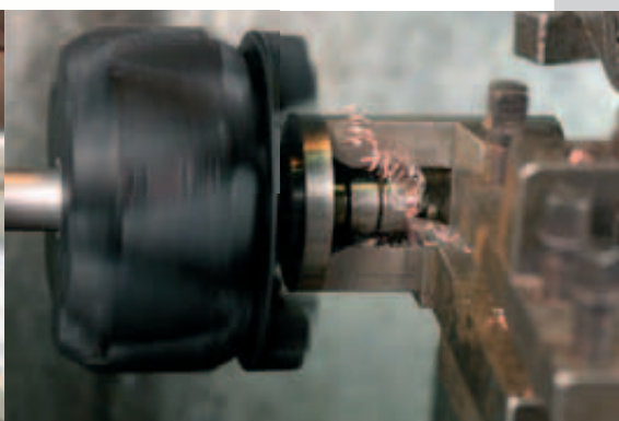
Abdrehen der Schleifringe am Rotor.
