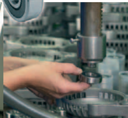
Einpressen der neuen Wälzlager ins Lagergehäuse.
