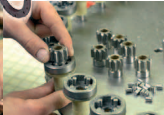
Montage der Freilaufgetriebe, Einsatz eines neuen Ritzels.
