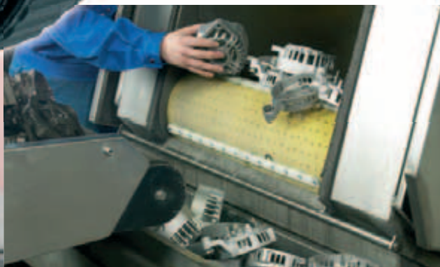
Nassstrahlanlage für die Reinigung der Einzelkomponenten.
