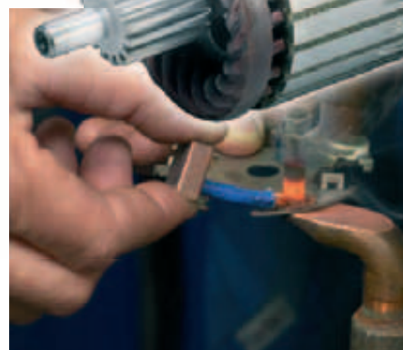
Neue Kohle wird auf den Kohlehalter aufgeschweißt.
