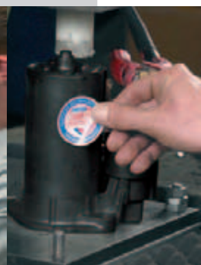
Prüfsiegel wird nach erfolgreicher Endprüfung aufgeklebt.
