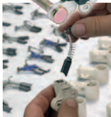
Erneuern der Kohlen und Montage in den Halter.
